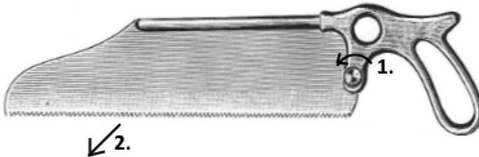
3. Das Instrument ist demontiert.
