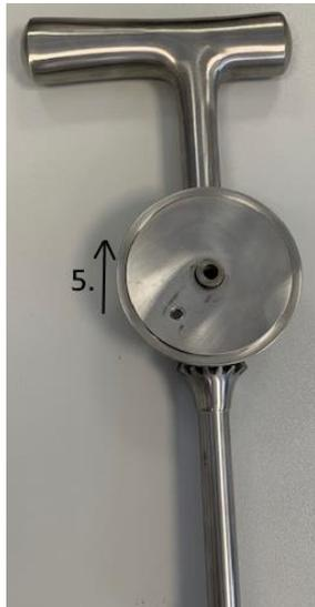
6. Den Adapter vom unteren Ende des Handbohrapparats schrauben.
