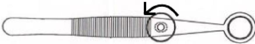
2. Das Instrument ist demontiert.
